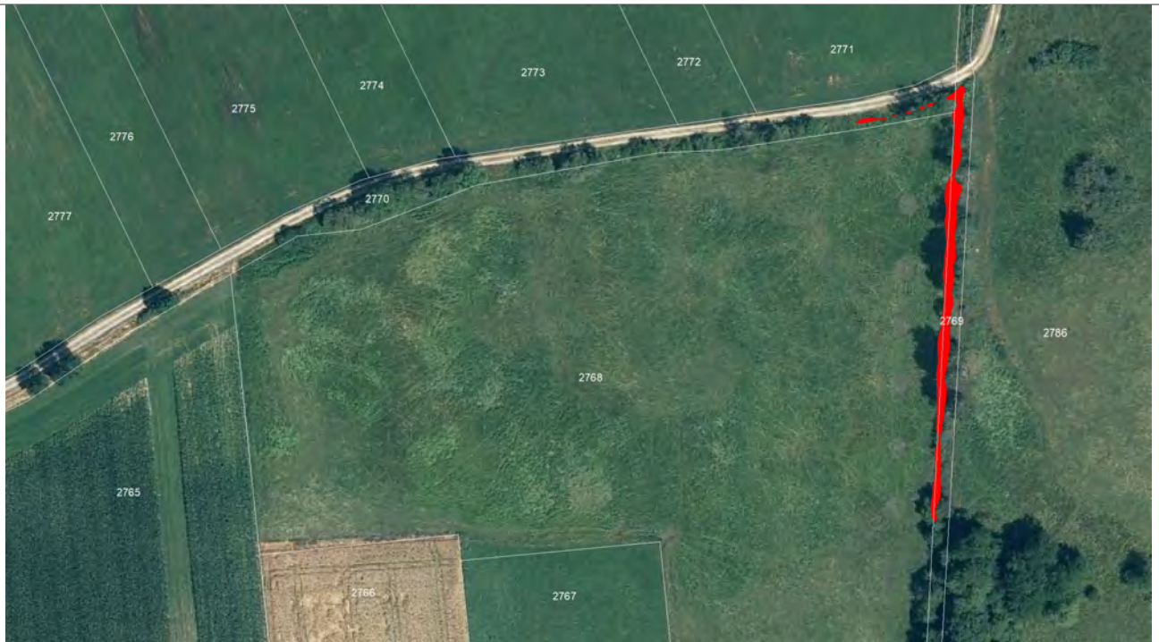
Sichtbarer Rückstau im Graben bei Anhebung des Wasserstandes auf 379 m ü.N.N.
