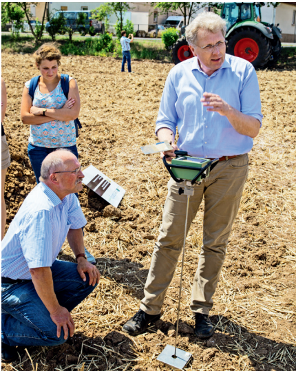
Abb. 3: Ermittlung des Eindringwiderstands als Maß für die Ausprägung von Bodenverdichtungen.
