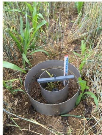
Abbildung 4: Doppelringinfiltrometer im intensiv bearbeiteten Bereich (links) und im Direktsaat-Bereich (rechts)
