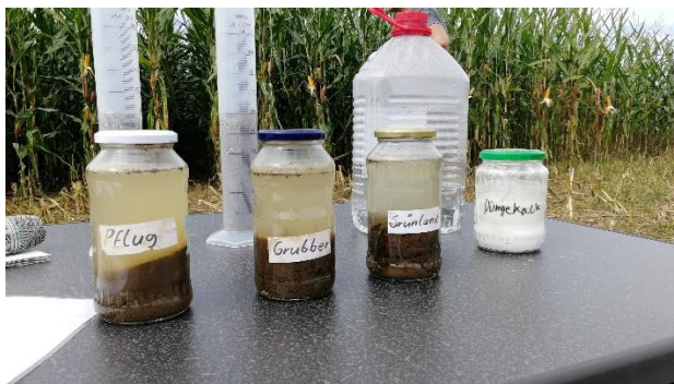
Abbildung 6: Schauversuch zur Bodenstabilität in Einmachgläsern © AELF Rosenheim
