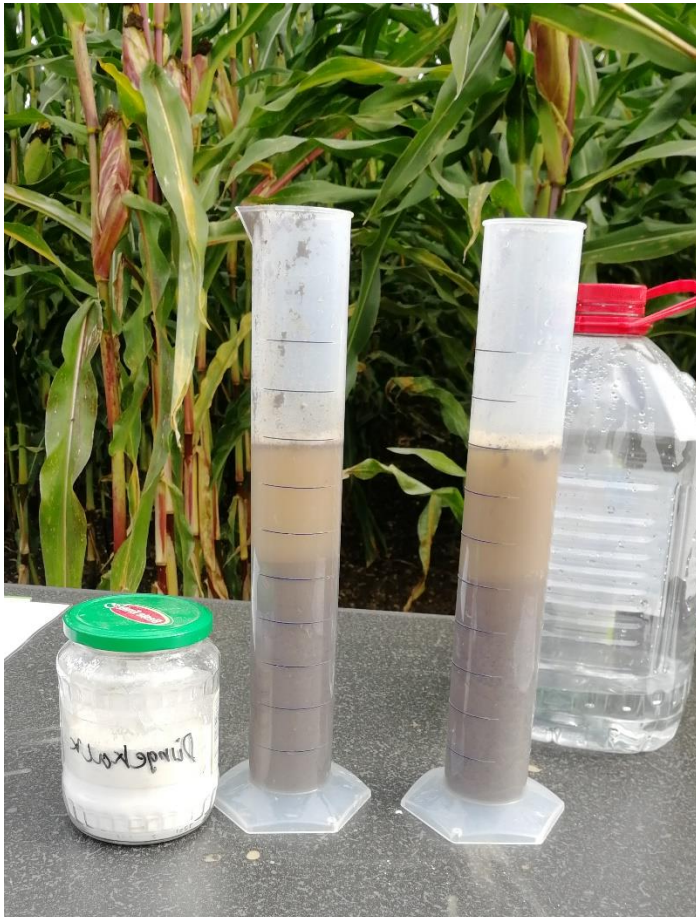
Abbildung 7: Schauerexperiment mit Bodenproben aus Pflug- und Grubber-Variante unter Zugabe von Kalk © AELF Rosenheim
