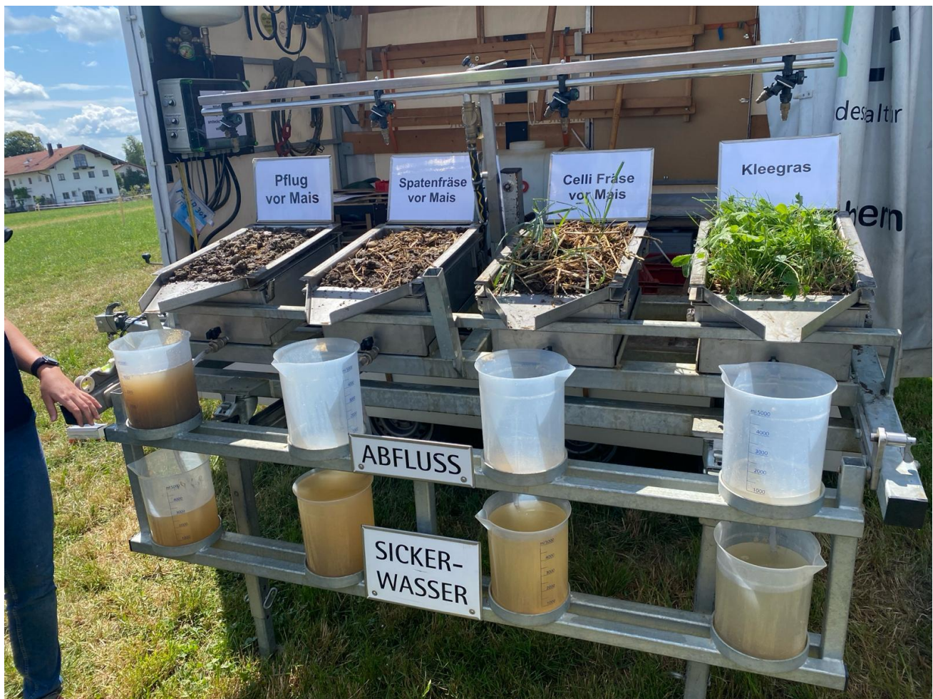
Abbildung 8: Regensimulator: 55 Liter Niederschlag innerhalb 5 Minuten führen beim Pflugeinsatz vor Mais zu deutlicher oberflächlicher Erosion
