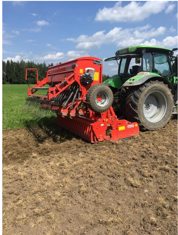
Abbildung 10: Enterden der Graswurzeln zum besseren Abtrocknen mit der Kreiselegge
