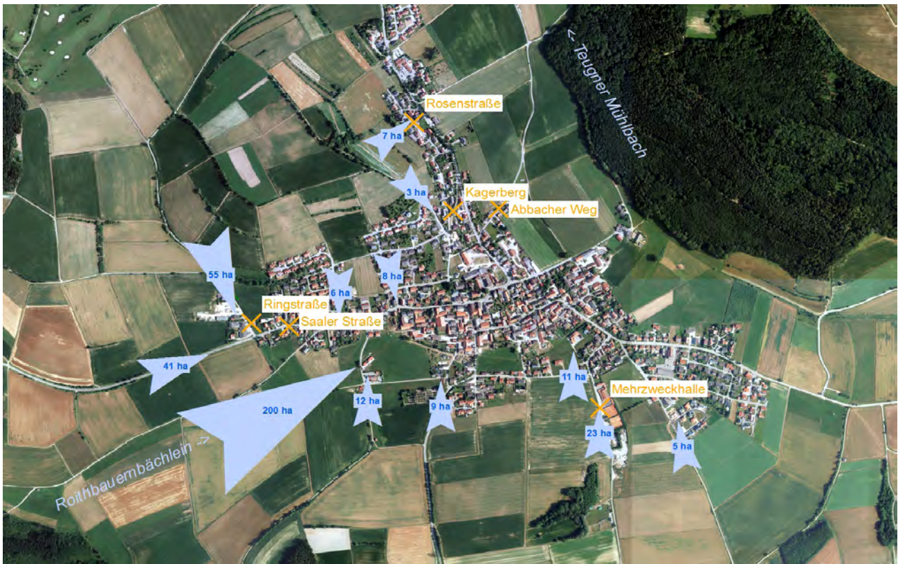
Problemstellen und Wasserzutritt
