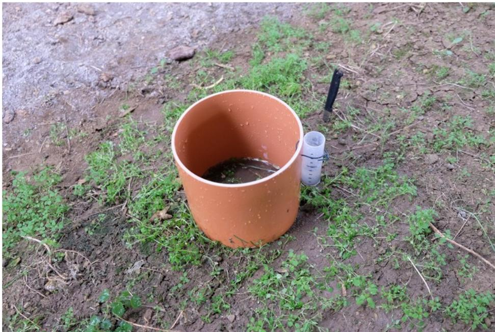
Einfaches Infiltrometer: PVC-Rohr mit Schneidkante, die in den Boden gedrückt wird. Mit dem angebautem Röhrchen wird die mittels Gießkanne über dem Rohr und dem umgebenden Boden aufgebraachte Beregnungsmenge bestimmt. Foto: DöhlerAgrar / Schmidt & Partner
