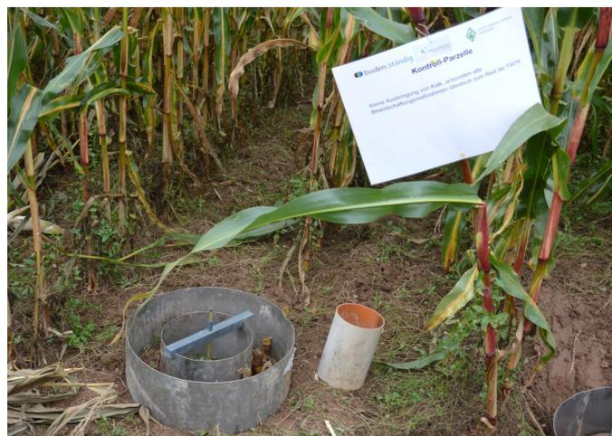
Abb. 2: Infiltrationsmessung im Mais (Batrla ILE Kahlgrund Spesart)
